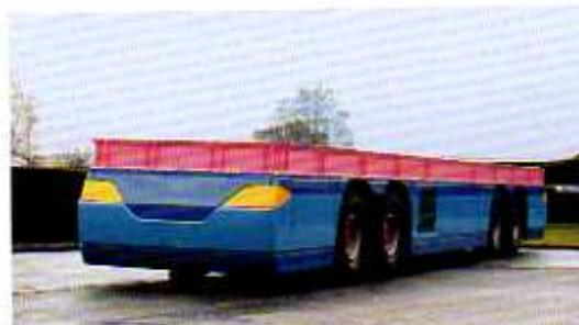
Ein ferngesteuerter, selbstfahrender Containertransporter wurde von NAW gebaut.
