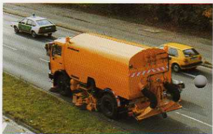
Linksseitiges Kehren mit dem fließenden Verkehr
