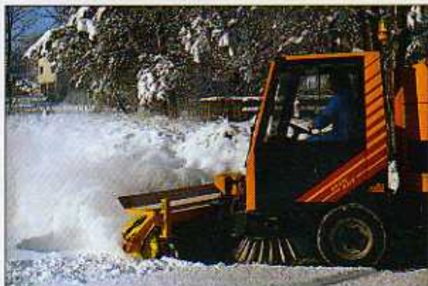
Die Schneeräumwalze. Hydraulischer Antrieb – schwenkbar – grosse Räumleistung – lieferbar mit Stahl- oder Polyborsten.
