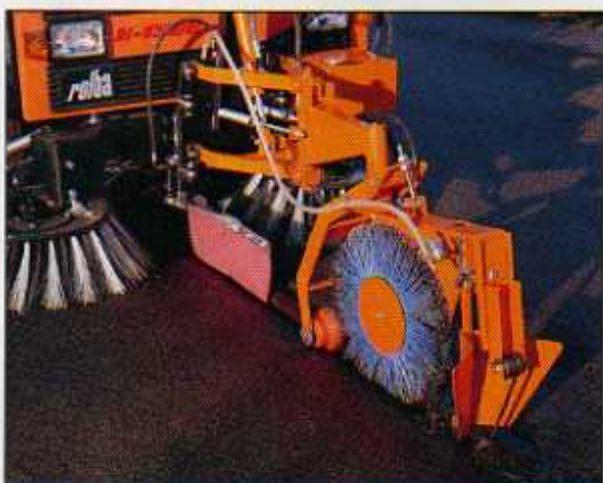
Der Gleisreiniger. Zum Entfernen von grobem Schmutz aus vertieften Gleisen.
