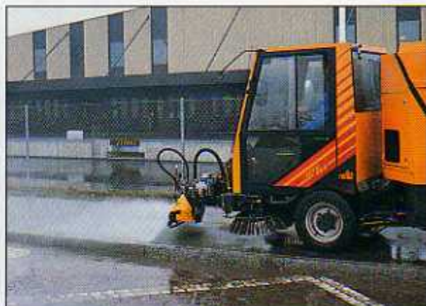
Die Schwemmanlage. Die Wasserreinigung löst Schmutz und Staub porzentief – Teleskop-Schwemmbalken – schwenk- und ausfahrbar – regulierbarer Wasserdruck.
