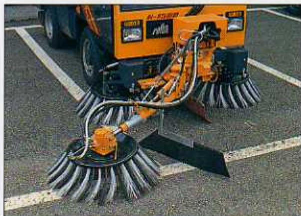
Der dritte Besen. Zum Kehren auf verschiedenen Ebenen, aus Ecken heraus und um Vorsprünge herum. Links und rechts einsetzbar.
