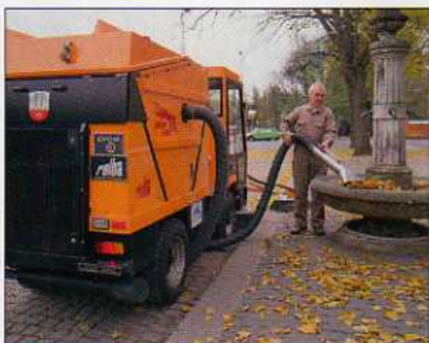
Der Saugschlauch. Zum Laubsaugen, Entleeren von Papierkörben und reinigen von Rabatten oder unter Sträuchern etc.
