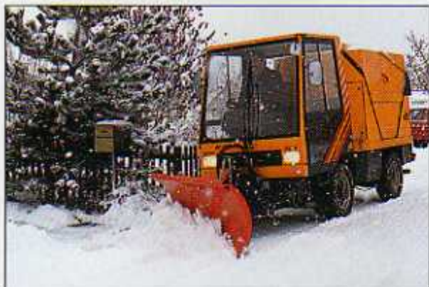
Der Schneepflug. Die rationelle Schneeräumung auf Gehsteigen – Parkplätzen etc. Links und rechts schwenkbar.
