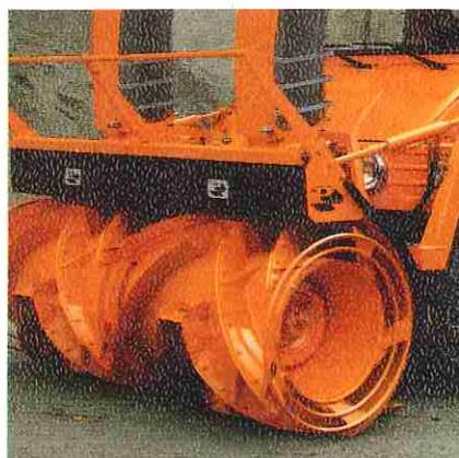
Alle nötigen SUVA-Schutzeinrichtungen, wie Haltestangen, Kaminbügel, doppelte Abweisinge, Kaminreiniger, Überführungssicherung und Stöpsel mit Halterung, sind am Fräsaggregat montiert.
