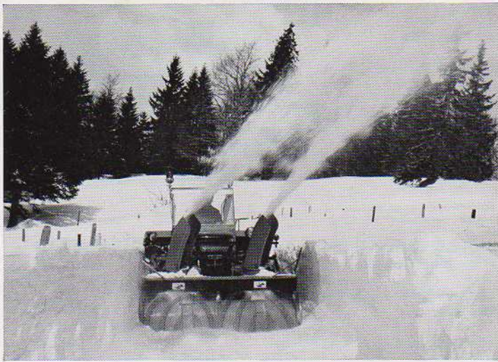
Peter-Schneefräse mit Zapfwellenantrieb, Traktor min. 45 PS und ausgerüstet mit Kriechgängen
